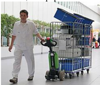
Figura 145 equipo de tracción manual tractor de arrastre eléctrico mover (gentileza de Worktech)
