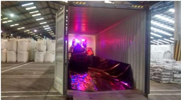
Container se posiciona a nivel del piso, y grúa ingresa sacos organizados en eslingas. Las eslingas se posicionan en dos niveles.
