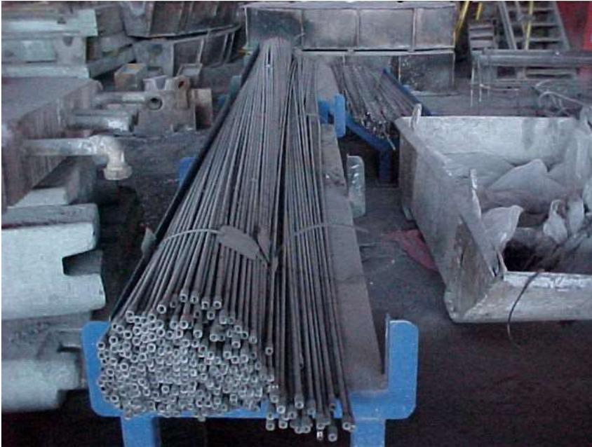
**Las “paipas” se utilizan para inyectar oxígeno al cobre fundido y se vuelva más viscoso.**
